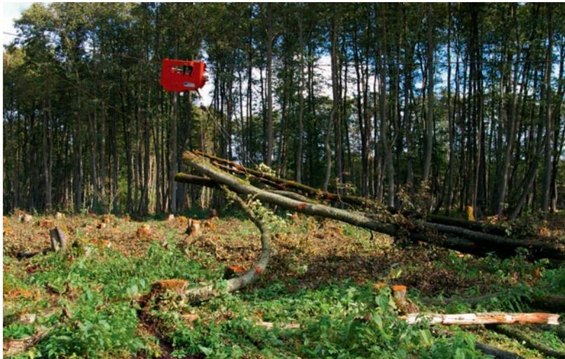
**Foto 21** (links): Das seitliche Beiseilen mehrerer Stämme zur Seilkrantrasse im so genannten Schleifrückeverfahren, bei dem die Bäume an der Stammbasis angehoben werden.
