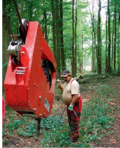
**Foto 19** (links): Die im Projekt eingesetzte mobile Seilkrananlage vom Typ VALENTINI V 1000.
