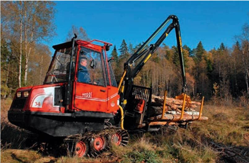
**Foto 17:** Die neu entwickelte *TERRI 34* im Rückeeinsatz auf Nassstandorten (Quelle: Forsttechnik Volker Koch, Klocksinn; <http://www.forsttechnik-koch.de/technik/terri/index.php>).
